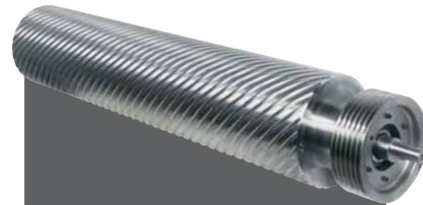
Schrägverrippte Stahlwalze mit Durchmesser 140 mm (160 mm für Version "rr"). Unerlässlich beim Kalibrieren mit starker Spanabnahme, auch auf hartem oder knotigem Massivholz und Massivholz mit unterschiedlicher Maserung.
