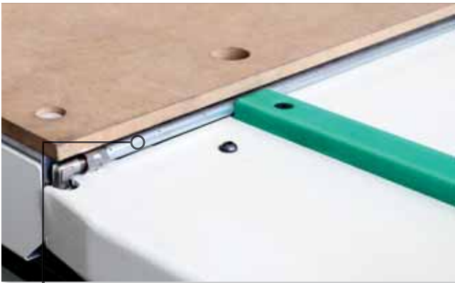
System zur Plattenreinigung gewährleistet eine optimale Halterung: durch Mikro-Wasserstrahlen erfolgt die Plattenreinigung am Ein- und Auslauf des Arbeitstisches; Werkzeugwechsler mit automatischem Hub (Scm Patent)
