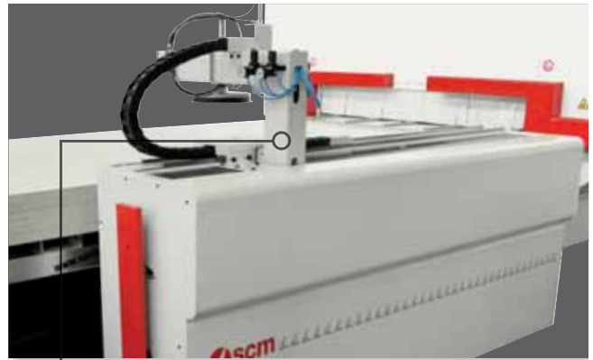
Ausrichter am Werkstückeinlauf ideale Lösung, um die Leistung der Arbeitszelle von der Ausrichtungsqualität des Plattenstapels zu befreien
