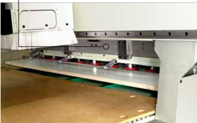
Hubtisch mit Saugern und Blasdüsen system für die Plattenreinigung
