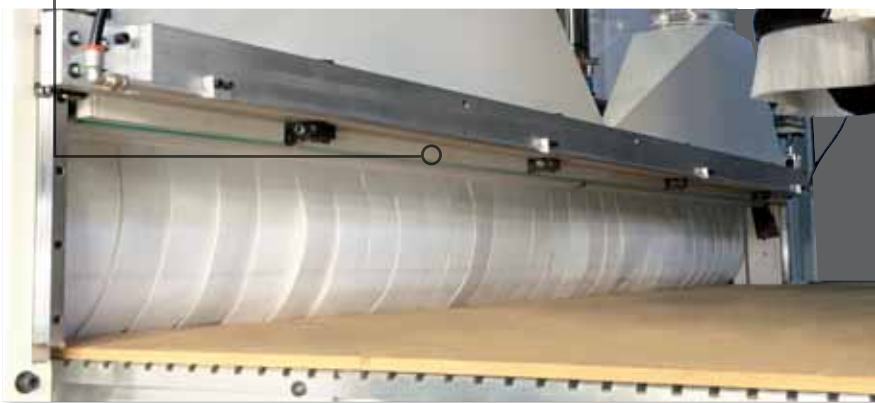
Schieber für den Plattenausschub mit Blasdüsensystem für die Plattenreinigung
