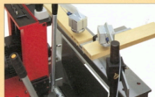
▲ Bohren von Längs- und Quersfrisen. Drilling of rails and stiles. Perçage des frises longitudinales et transversales.
