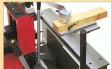
▲ Bohren in zwei Ebenen. Drilling in two levels. Perçage sur deux niveaux.
