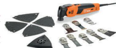
**Technische Daten:** Mit Anti-Vibrationssystem; Starlock Werkzeugaufnahme-Standard; 100% verlustfreie Kraftübertragung für bis zu 35% mehr Arbeitsfortschritt. QuickIN Werkzeugwechsel. Patentiertes werkzeugloses FEIN Schnellspannsystem; Tachogenerator für konstante Drehzahlen auch unter Last. Stufenlose elektronische Drehzahlstellung. Integrierte Schnittstelle für zusätzliches Systemzubehör wie Tiefenanschlag u.a.m.
